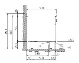
Electrical inlet (power) Equipotential screw
